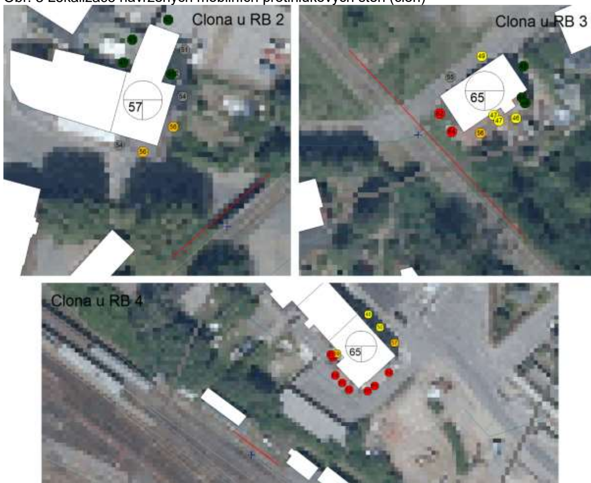
Obr. 3 Lokalizace navržených mobilních protihlukových stěn (clon)
